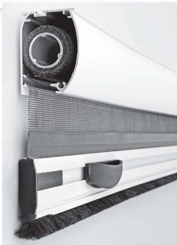
kutija rolo komarnika sa mrežicom, klizni profil, pogonska ručica i četkica
