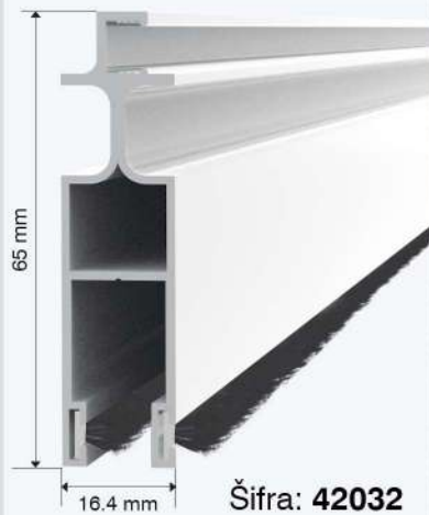
PRESEK KLIZNOG PANELNOG KOMARNIKA PRESEK KRILA I VODILICE
